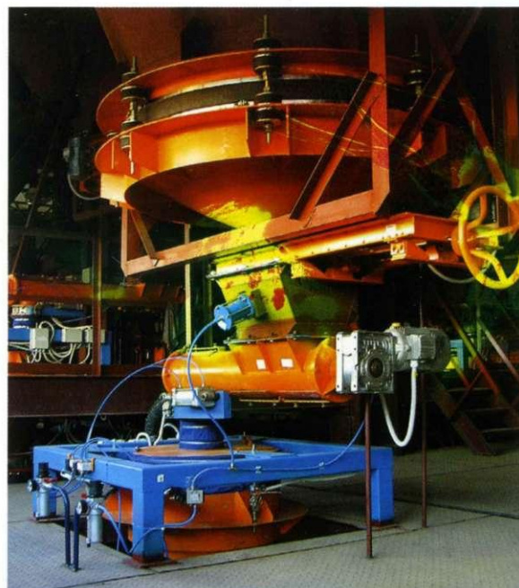
РИС. 3 Вибрационное дноще с шибберным затвором и пневматическим ударником.
